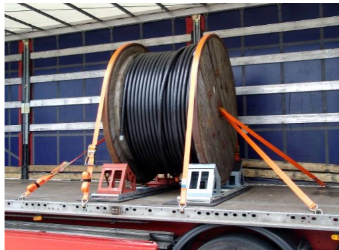
Das flexible GWS®-FlexSis 280 PLUS Rollensicherungssystem im Einsatz zur Sicherung einer Kabeltrommel
